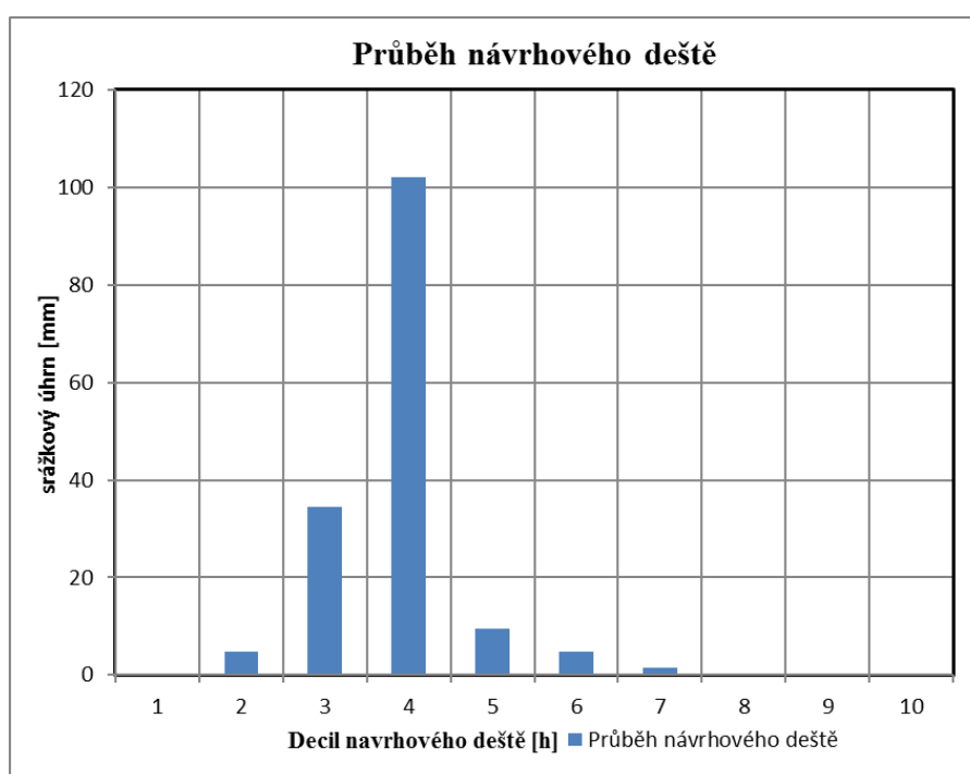
Graf 1. Návrhový dešť a jeho pravděpodobnostní rozdělení dle ČHMÚ, malé povodí do 4 km 2
